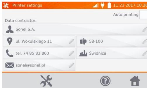
Al hacer clic en los campos individuales, se pueden modificar los datos de las mediciones que se imprimirán. Marcar la casilla **Auto impresión** hace que se imprima automáticamente la impresión al guardar el resultado en la memoria, si la impresora está encendida.
